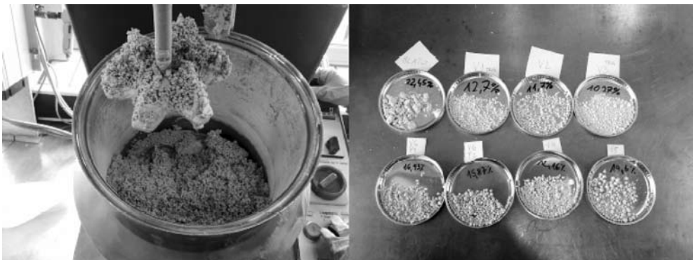
Slika 9., 10.: Prikaz mešalnika ERICH in prikaz testiranih vzorcev z merjeno količino vlage.
